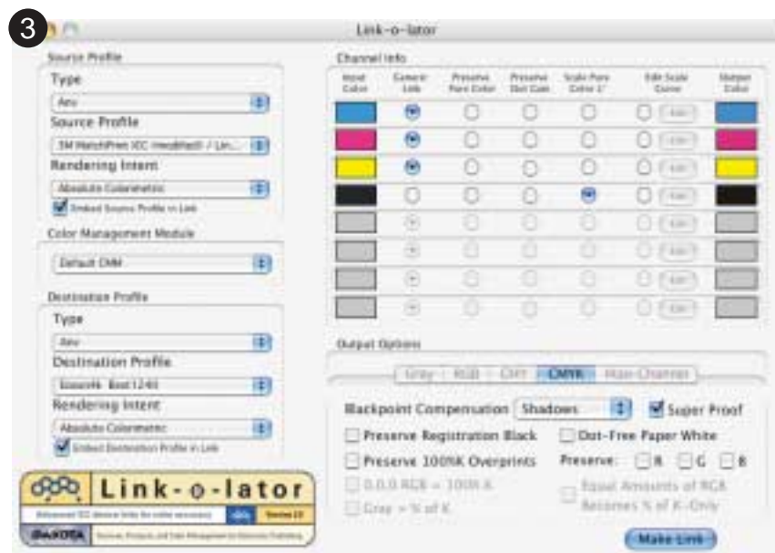
Основное окно программы Link-o-Lator для создания Device Link. В левой части выбираются профили, объединяемые в Device Link, в правой части — раздельная настройка цветовых каналов (не только чёрного, но и всех остальных!) и дополнительных опций, например, компенсации различий уровня чёрной точки у связываемых профилей
