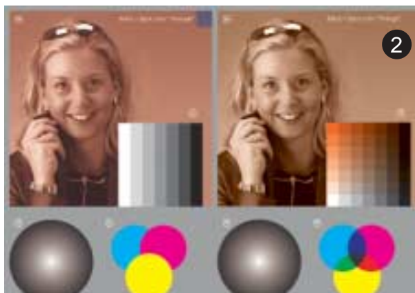
Воспроизведение тестовой формы Altona Test Suite. Справа — корректное, слева — нет (неверно отпечатааны оверпринты в местах пересечения окружностей первичных цветов внизу справа, а также «дуотон» Black+Orange на фотографии)
