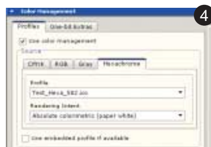
Окно задания входных профилей для разных цветовых моделей входных файлов в ColorProof XF RIP. При отправке в RIP 6-красочного файла (Hexachrome) на принтере будет получена цветопроба, имитирующая печать Hexachrome печатной машины, чей профиль указан
